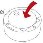
6. Schließen Sie die Abdeckung des Wassermelders, indem Sie sie im Uhrzeigersinn drehen.
