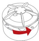
2. Nehmen Sie die Testtaste/den Deckel ab, um Zugang zur Batterie und dem Schiebeschalter für den Funk-Lernmodus zu haben.
