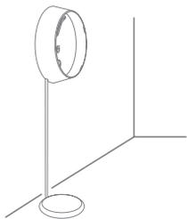
**HINWEIS:** Der Montagesockel für die Wand mit Sonde ist ein Ergänzungsteil für den Wassermelder. Er muss separat gekauft werden.
