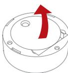
3. Entfernen Sie zuerst den Streifen, der die Batterie isoliert, wie dargestellt.
