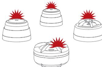
Blinkt die rote LED bei allen Warmmeldern, sind sie vernetzt; der „Lernmodus“ kann ausgeschaltet werden und die Installation beginnen.
